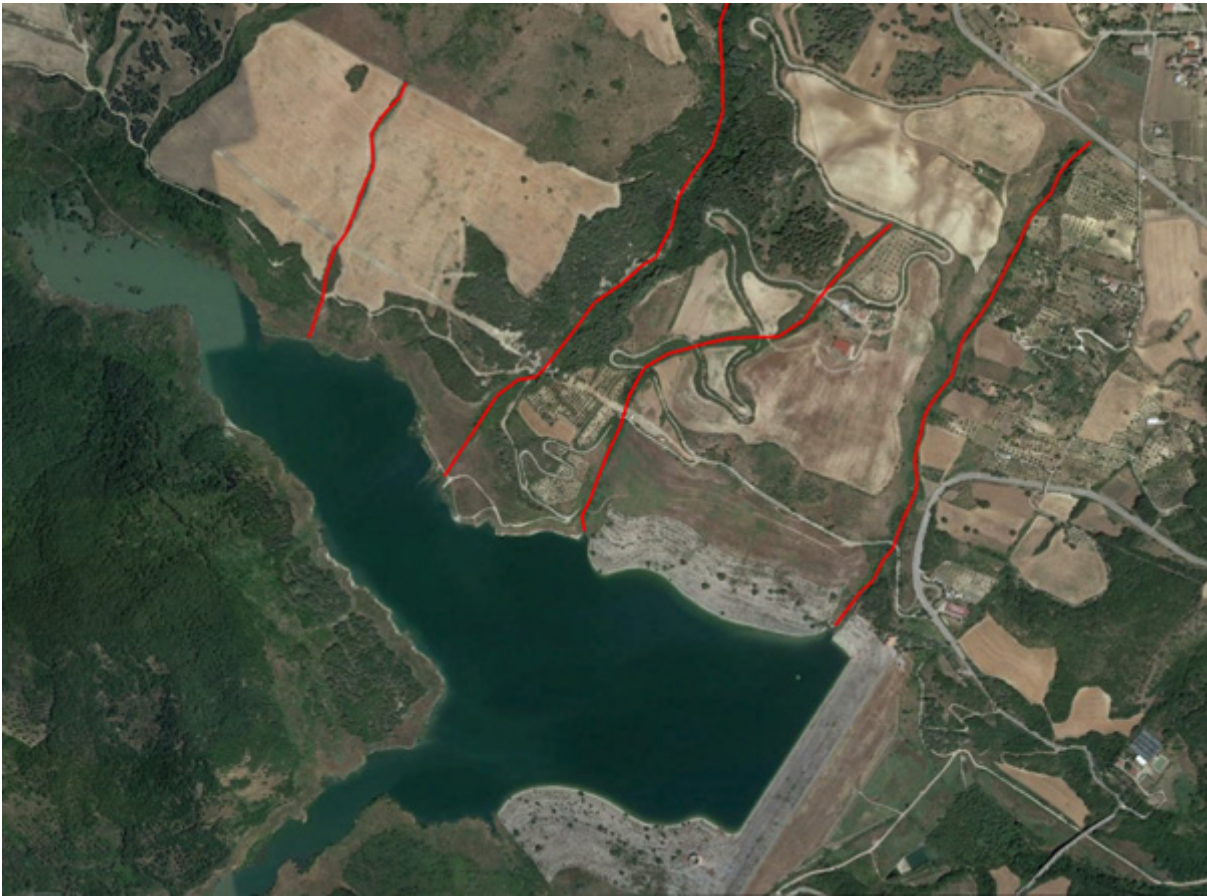
Figura 9.1: Fossi in erosione presenti sulla sponda sinistra dell'invaso di Acerenza.
