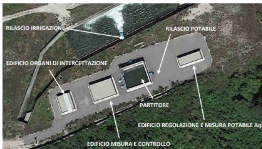
Figura 4 - Vista dall'alto e nel dettaglio dell'edificio
