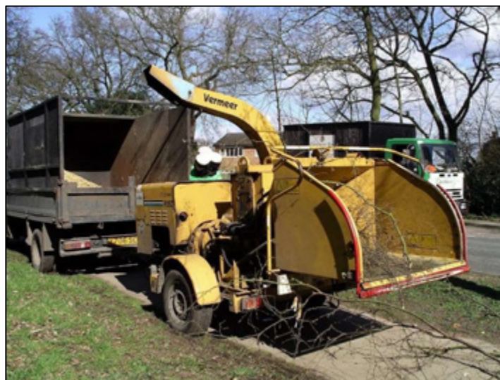
Figura 21 – Esempio di macchina cippatrice
