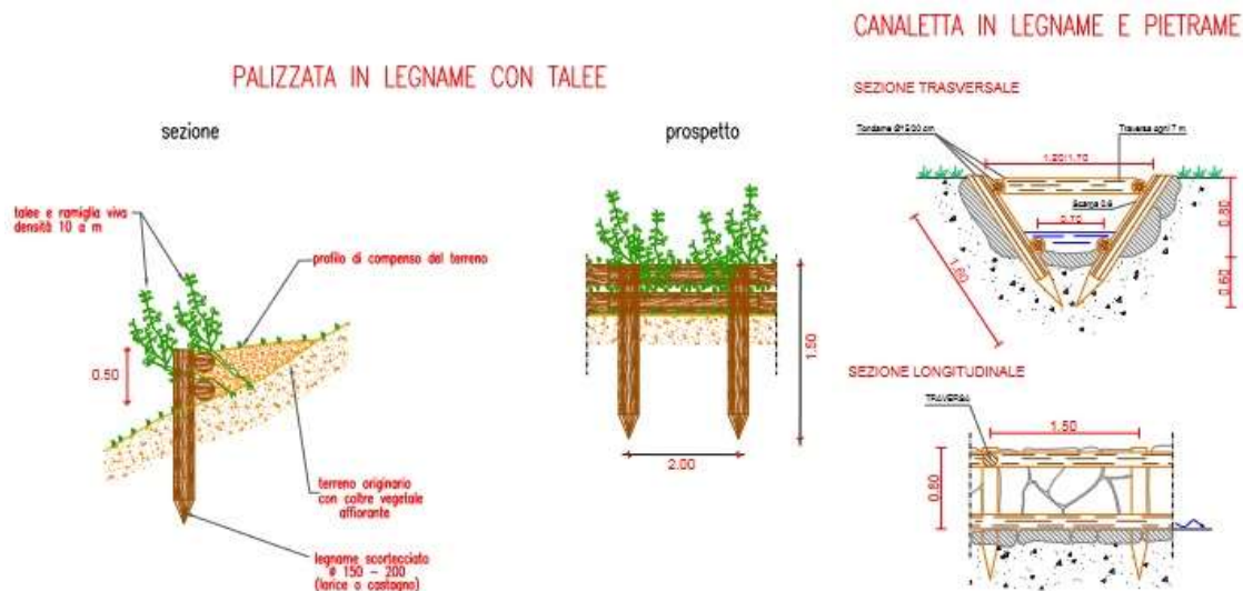
Figura 26 – Alcuni esempi di interventi di ingegneria naturalistica
